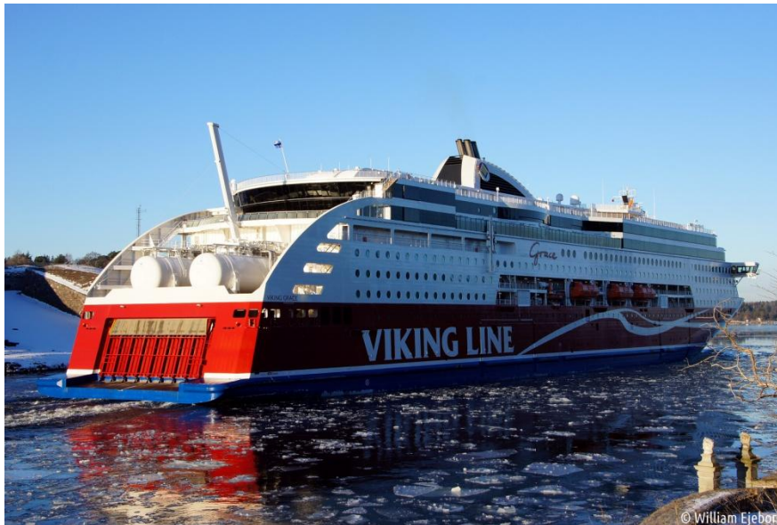
Joonis 1. Reisilaev “Viking Grace”, mis ehitati veeldatud maagaasile 2013.a alguses, on hetkel maailma kõige keskkonnasõbralikum laev. Pildilt on näha ühtlasi LNG mahutid (2 tk).
